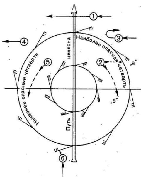
Это позволяет уйти в наименее опасную (левую переднюю) четверть циклона. Если пересечь путь движения циклона на значительном удалении от его центра не удается, то следует пытаться выполнить этот маневр даже на судах с мощными машинами.
